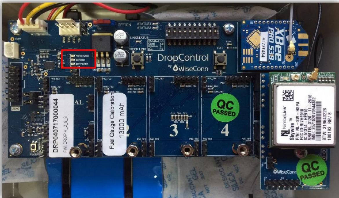
En la segunda posición observamos el LED CHARGE, encargado de indicar que el equipo se encuentra cargando la batería, este LED enciende de color verde.
